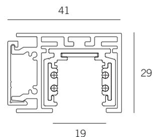
Peso telaio / Frame Weight 0,70 kg/m
