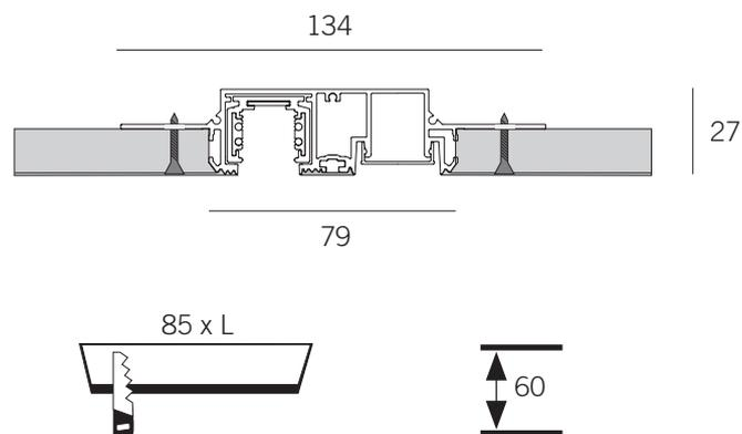
Peso telaio / Frame Weight 1,35 kg/m
